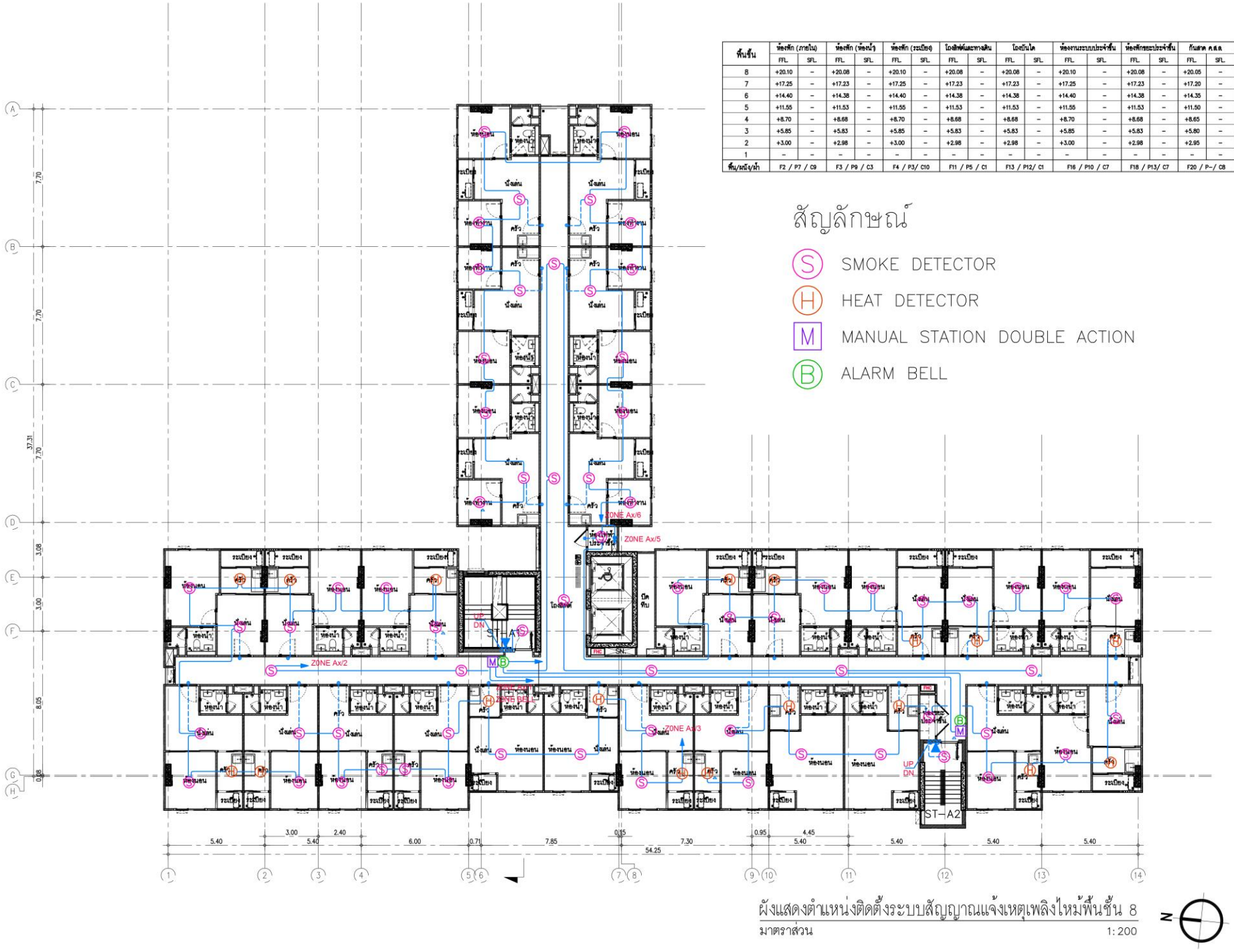
รูปที่ 2.8.1-6 ตำแหน่งติดตั้งระบบแจ้งเหตุเพลิงไหม้ อาคาร A ชั้นที่ 8
