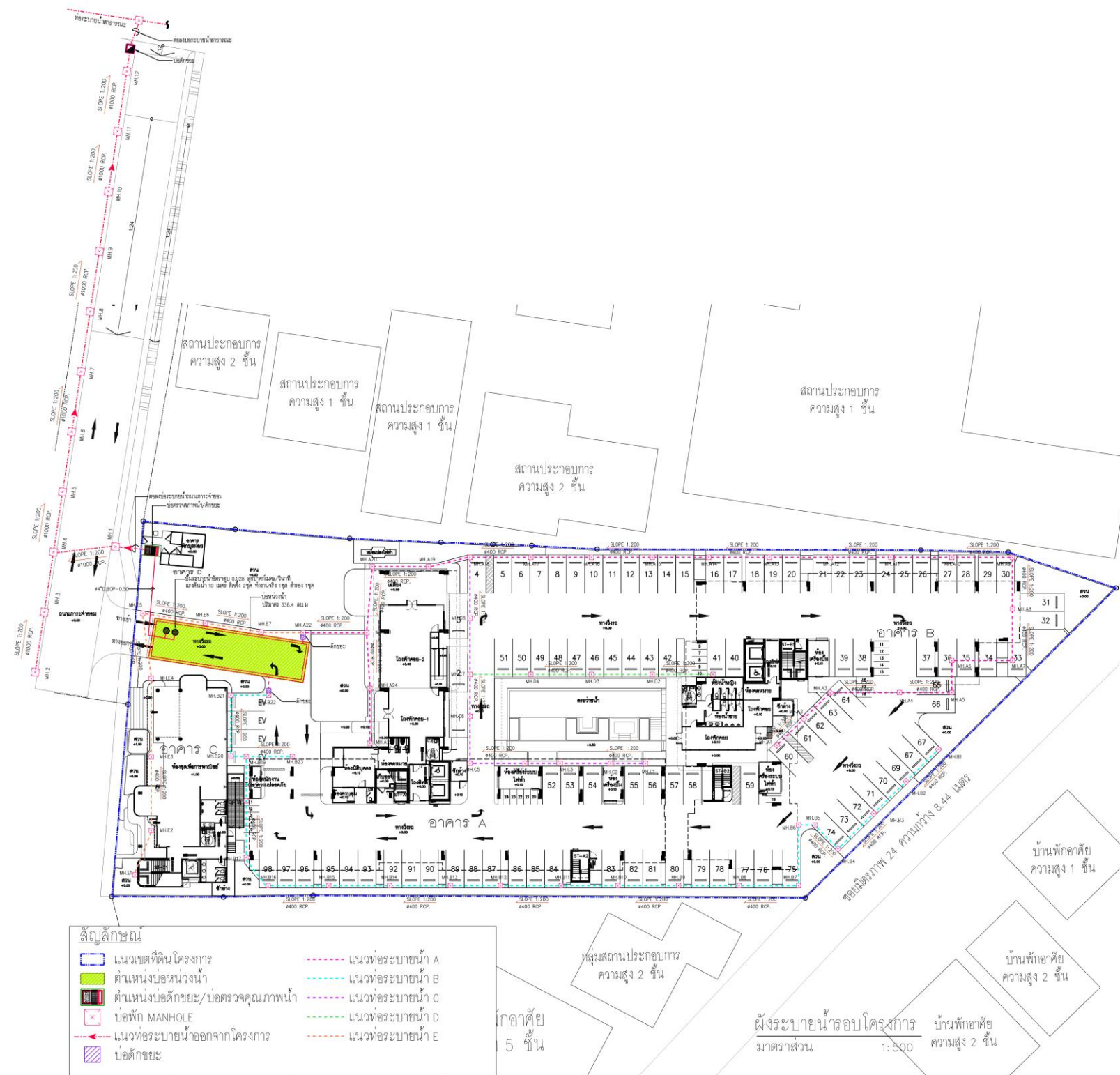
รูปที่ 2.7.3-1 ผังบริเวณระบบระบายน้ำรอบโครงการถึงจุดระบายน้ำสาธารณะ
