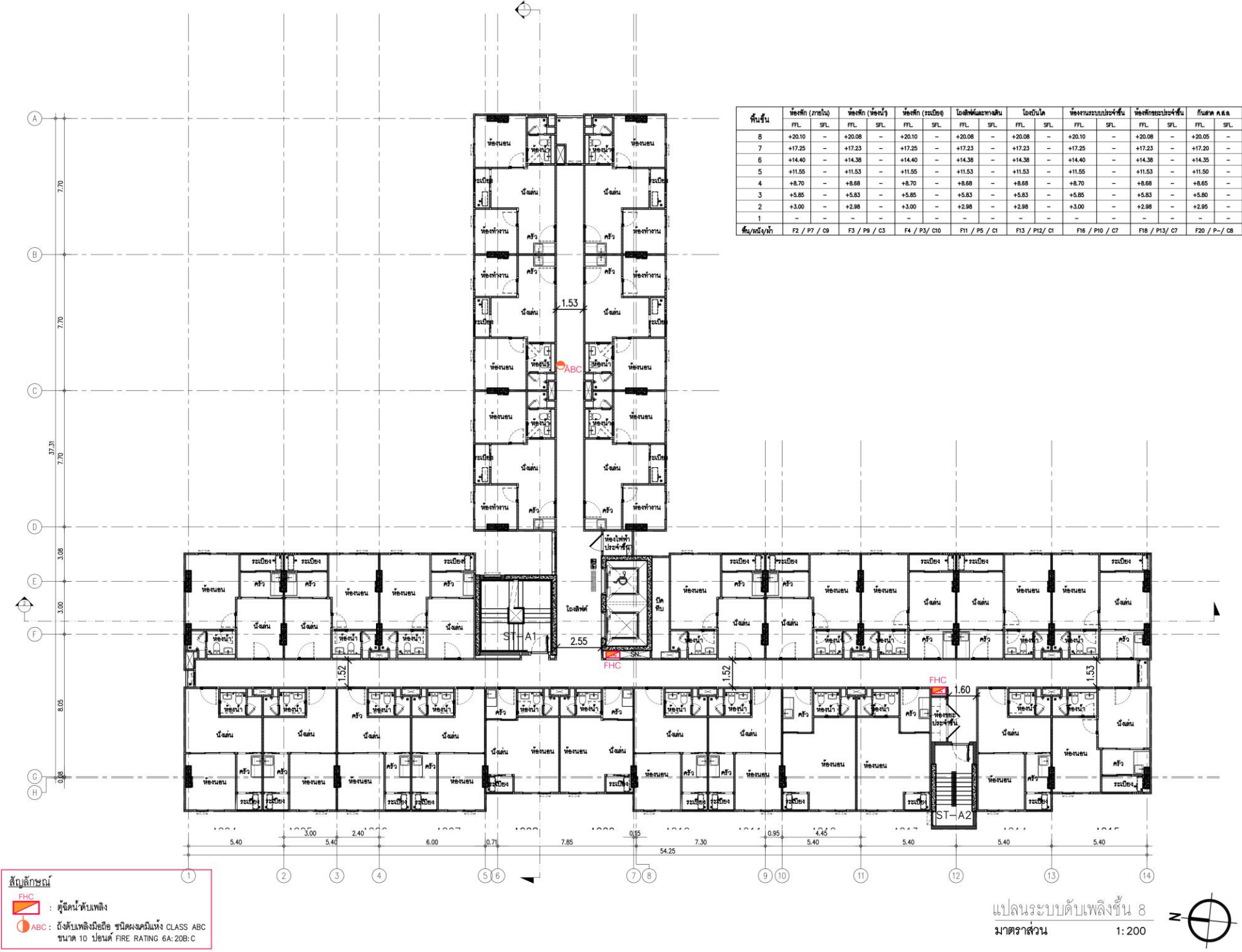
รูปที่ 2.8.2-8 ตำแหน่งตู้เก็บสายฉีดน้ำดับเพลิง (Fire Hose Cabinet: FHC) ของอาคาร A ชั้นที่ 8
