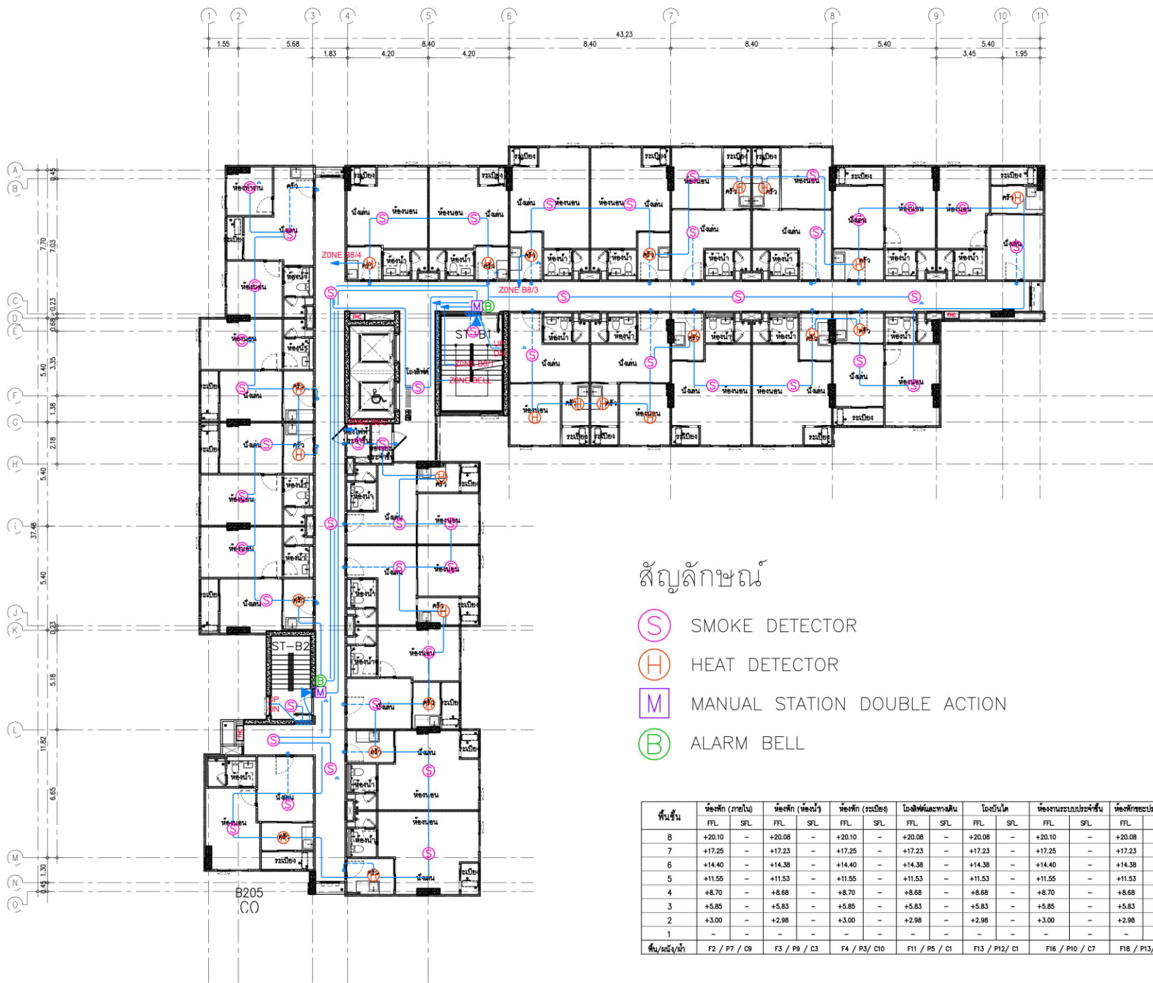
ผังแสดงตำแหน่งติดตั้งระบบสัญญาณแจ้งเหตุเพลิงไหม้พื้นที่ชั้น 8 มาตรฐาน 1: 200
